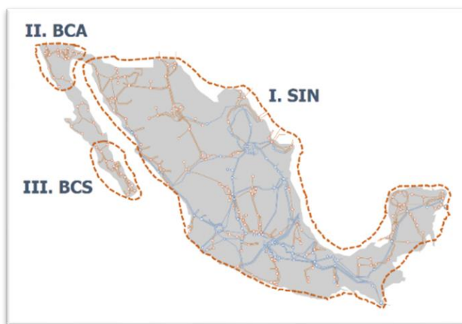
Fig. 4. Zonas de Potencia del Sistema Eléctrico Nacional
